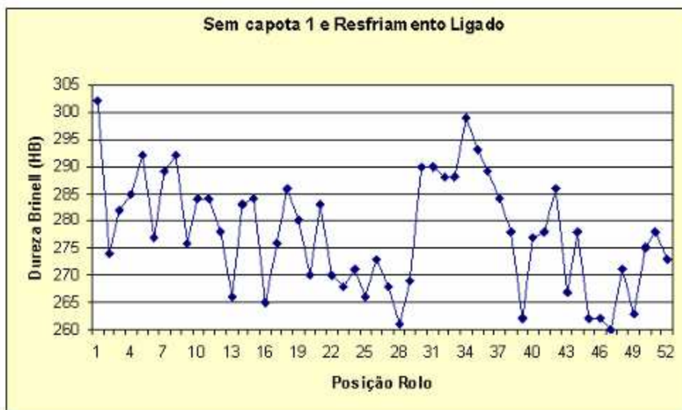
Figura 4-8 – Variação da dureza ao longo de espiras do rolo para condição 2.
