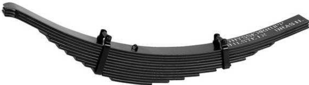
Figura 2-2 – Exemplo de mola semi-elíptica (feixe de mola) [3].
