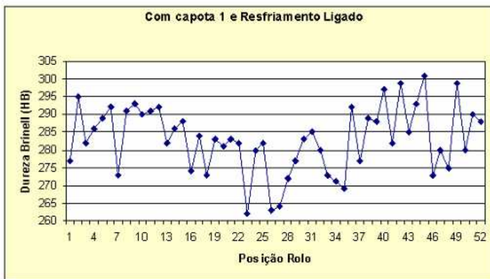
Figura 4-9 – Variação da dureza ao longo de espiras do rolo para condição 3.
