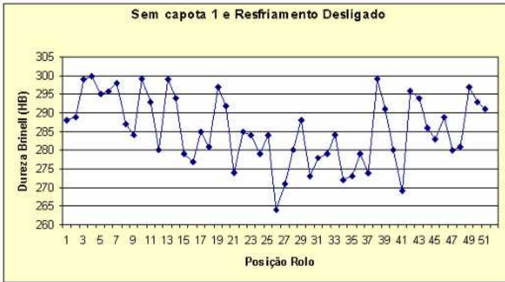
Figura 4-7 – Variação da dureza ao longo de espiras do rolo para condição 1.
