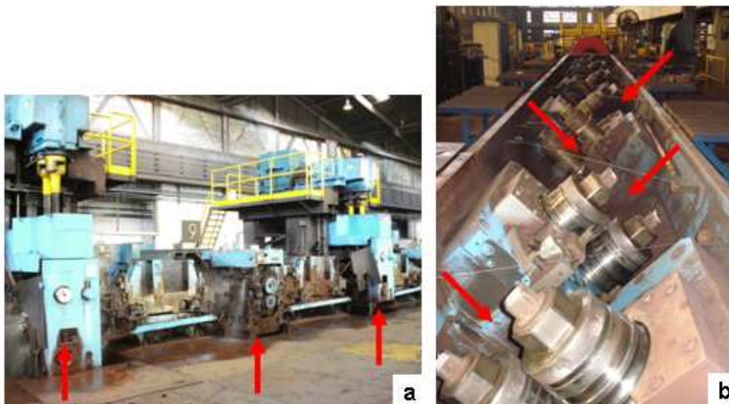
Figura 2-15 – Configuração para um arranjo contínuo a) Trem Intermediário b) Trem Acabador.
