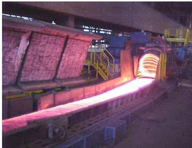
Figura 3-2 – Vista do cooling conveyor com as capotas de abafamento abertas.
