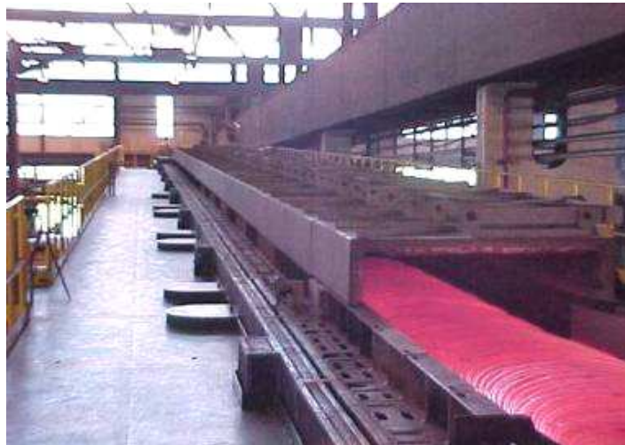
Figura 2-18 – Cooling Conveyor responsável pelo tratamento térmico final do fio-máquina.
