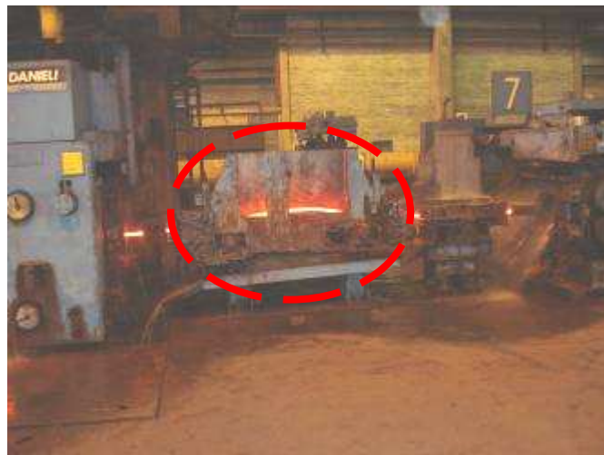
Figura 2-12 – Laço para controle da tração existente entre gaiolas.
