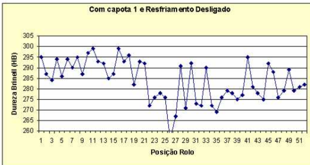
Figura 4-10 – Variação da dureza ao longo de espiras do rolo para condição 4.
