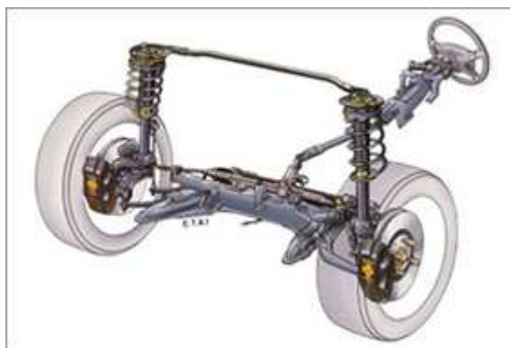
Figura 2-3 – Suspensão dianteira McPherson, com a característica de possuir um único braço de suspensão.
