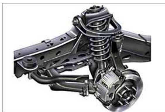
Figura 2-4 – Suspensão dianteira tipo Double Wishbone, com dois braços de suspensão.
