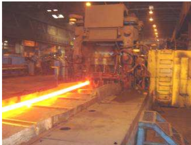
Figura 2-14 – Gaiola TRIO do laminador 2 de arranjo aberto.
