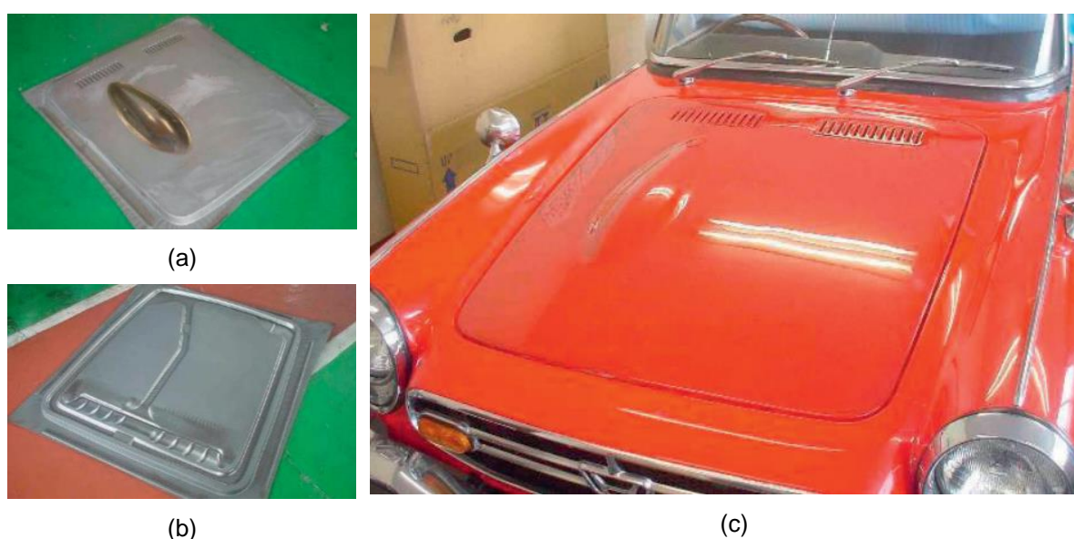
Figura 13: Capô do Honda S800 fabricado com Estampagem Incremental: (a) Parte superior do capô estampado, (b) Parte inferior do capô e (c) Capô montado no veículo [1]
