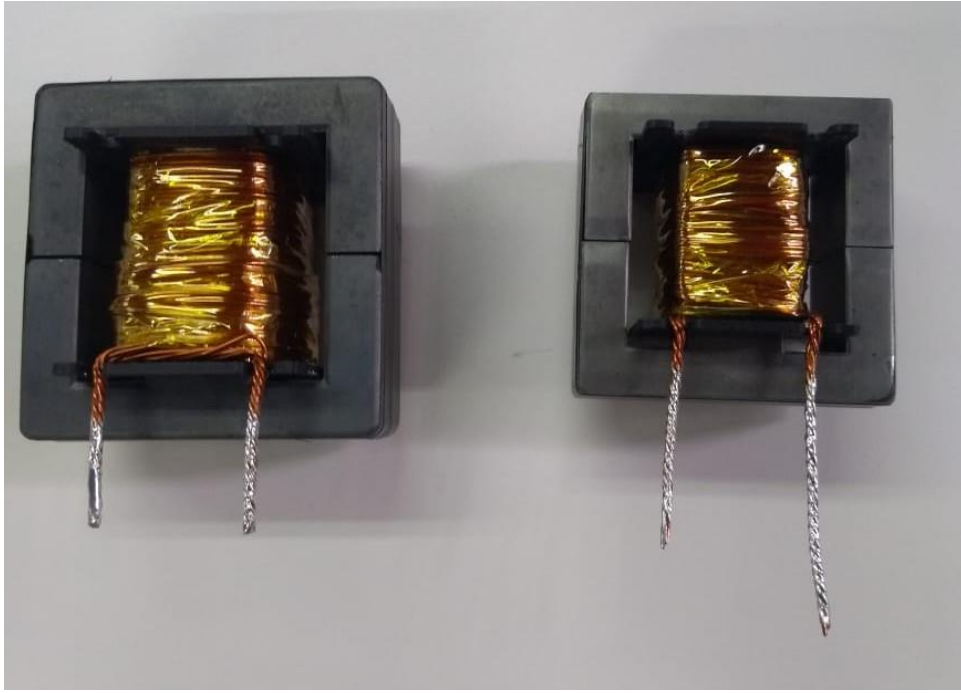
Figura 8 – Indutores confeccionados para o protótipo com indutâncias de 230 \mu\text{H} (esquerda) e 86,5 \mu\text{H} (direita).
