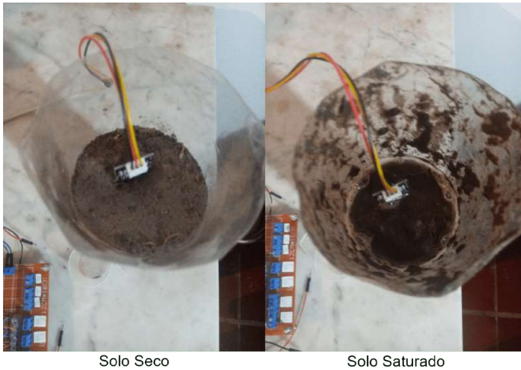
Figura 28: Ensaio Calibração Sensor de Umidade: Solo Seco e Saturado
