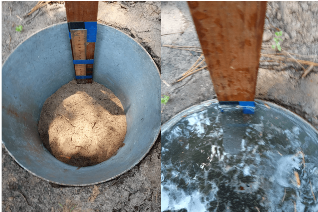
Figura 29: Ensaio Tempo de Absorção de Umidade pelo Solo
