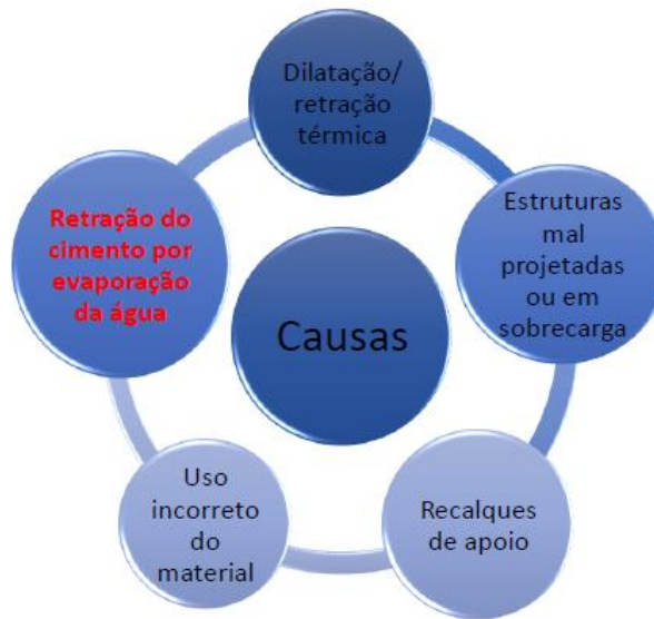
Figura 11 – Causas das fissuras
