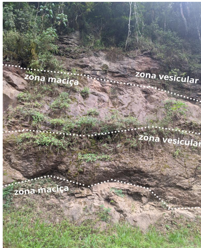
Figura 19 - Intercalação de zona maciça (centro de derrame) e zona vesicular (topo e base dos derrames) dos basaltos da Formação Gramado.
