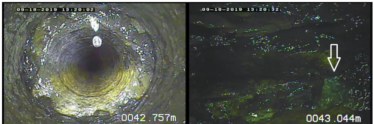
Figura 38 - Filmagem do poço 5498-FAB5, entrada de água em estrutura de contato entre derrames aos 42m.
