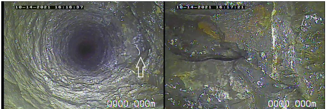
Figura 41 - Filmagem de poço em Paraí, entrada de água rasa, provavelmente proveniente do lençol freático
