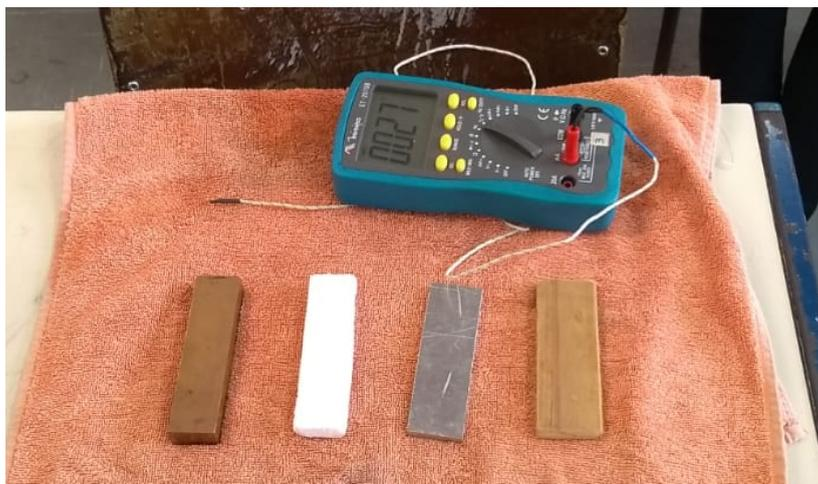
**Figura 16: Materiais utilizados para o experimento das pedras de gelo. Da esquerda para a direita temos os seguintes materiais: cobre, isopor, alumínio e madeira.**
