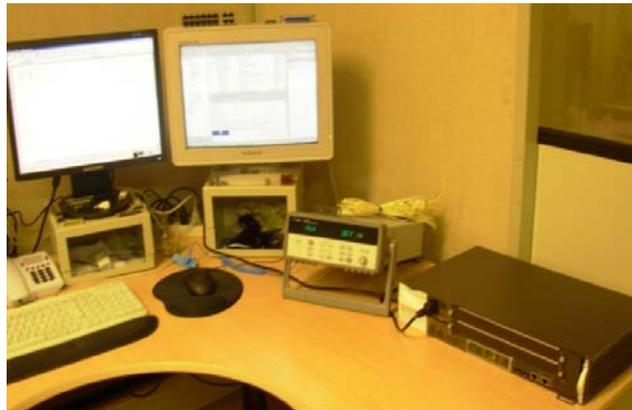
Figura 4 - Bancada montada para as medições experimentais do multiplexador.
