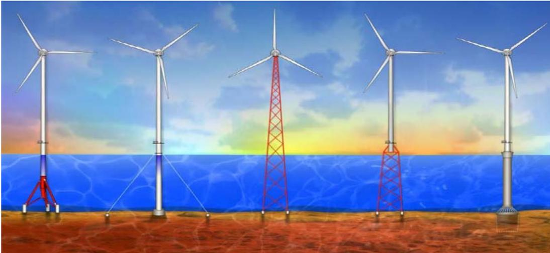
Figura 2.4: Fundações para Profundidades de Transição (fonte: NREL, 2006)
