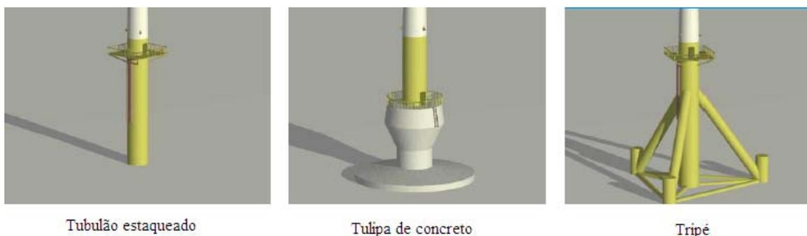
Figura 2.3: Tipos de Fundações Fixadas (fonte: NREL, 2006)
