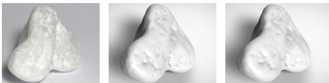
Figura 8. Da esquerda para direita, a pedra original, o modelo de malha poligonal e o modelo NURBS mais fiel ao modelo poligonal
