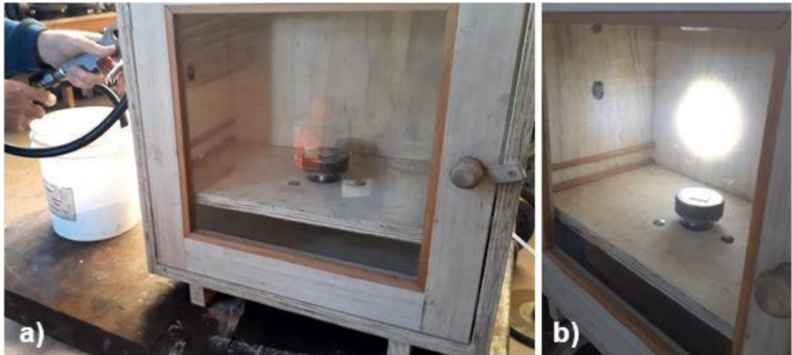
Figura 27. Procedimento de shot peening – Ângulo de 30°
