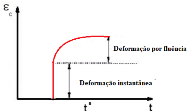
Figura 4.2– Evolução da deformação por fluência sob a aplicação de tensão constante
