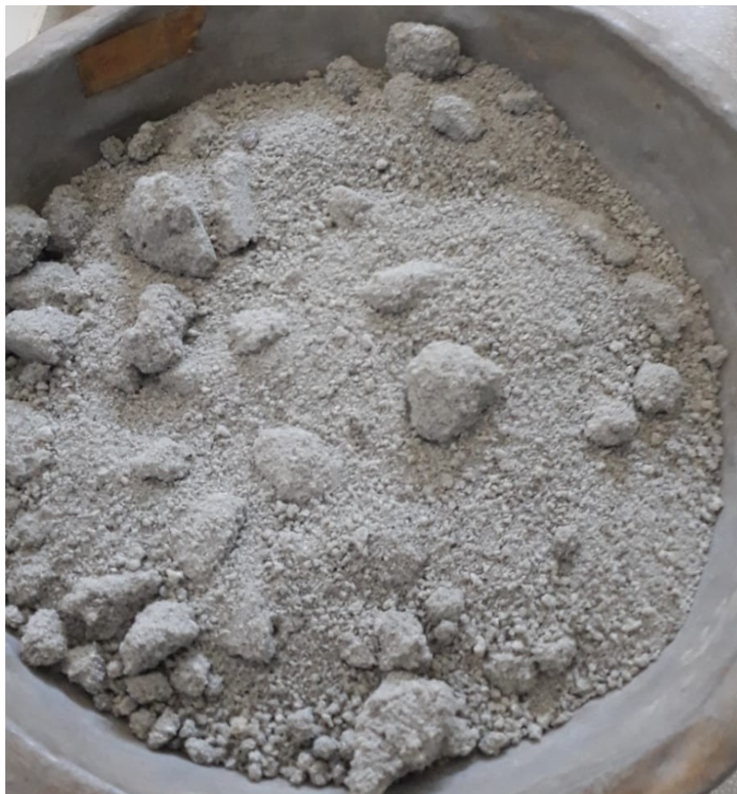
Figura 3.24 – Escória Granulada de Alto Forno utilizada no estudo.
