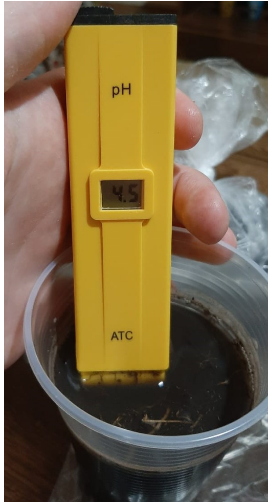
Figura 3.18 – PHmetro de bolso e resultado do ensaio.
