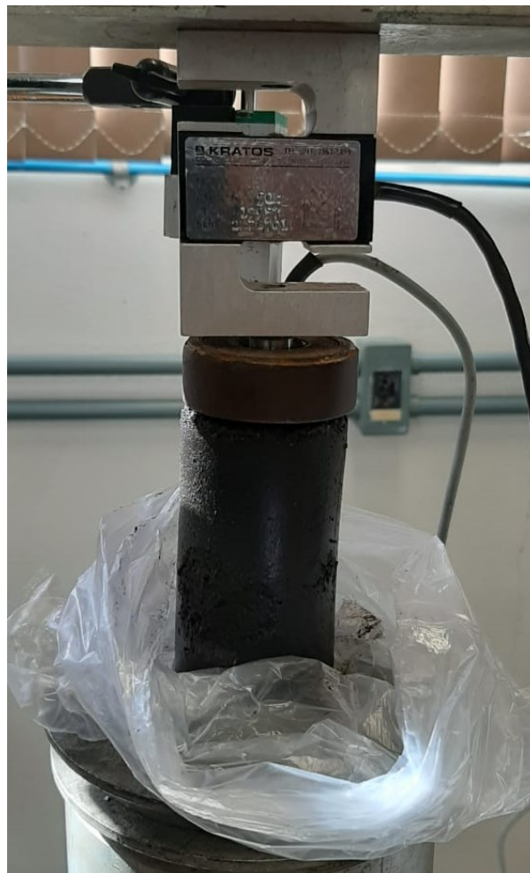
Figura 3.20 – Corpos de prova de solo remoldado para w=64\% .
