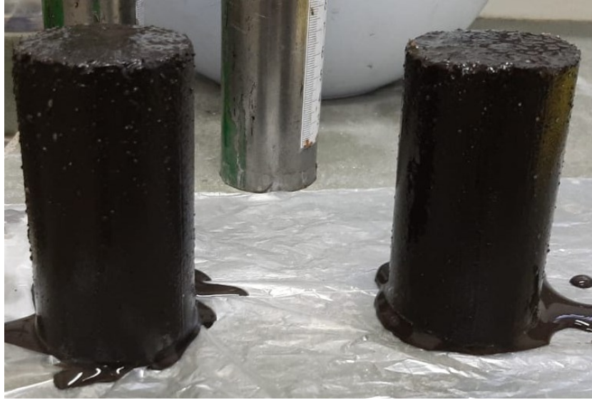
Figura 3.20 – Corpos de prova de solo remoldado para w=64\% .
