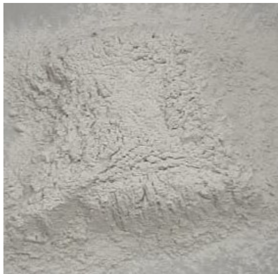
Figura 3.26 – Escória de alto forno moída e peneirada
