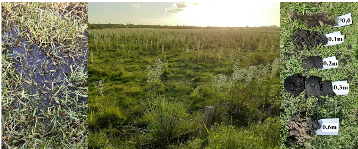
Figura 3.14 – Ao centro o ponto de coleta do solo; à esquerda a presença de água no terreno e à direita o perfil do solo até 60cm.
