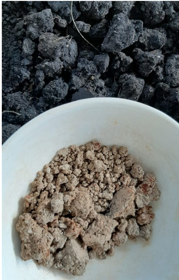
Figura 3.17 – Aspecto do solo antes (acima) e após (abaixo) ensaio de determinação da matéria orgânica por queima em forno do tipo mufla.
