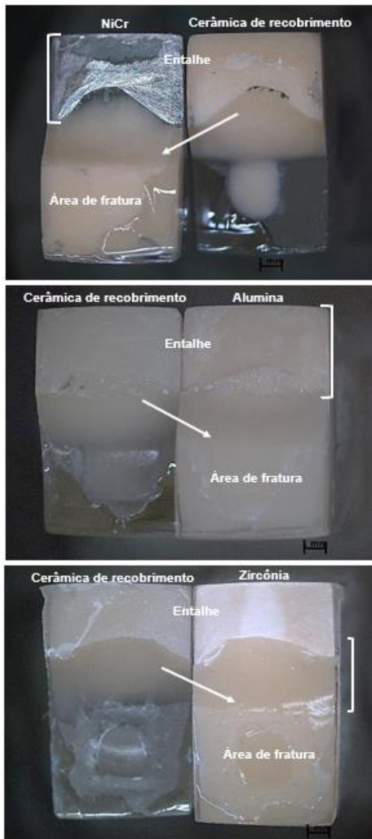
Figura 47 - Fraturas limitadas a cerâmica de revestimento. Vista superior das duas partes do corpo de prova após a fratura.
