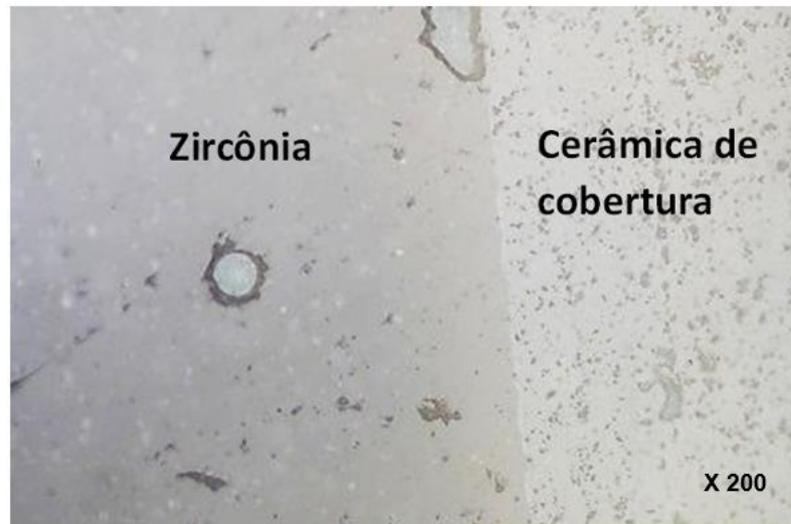
*Figura 35 - Interfaces zircônia/cerâmica.*
