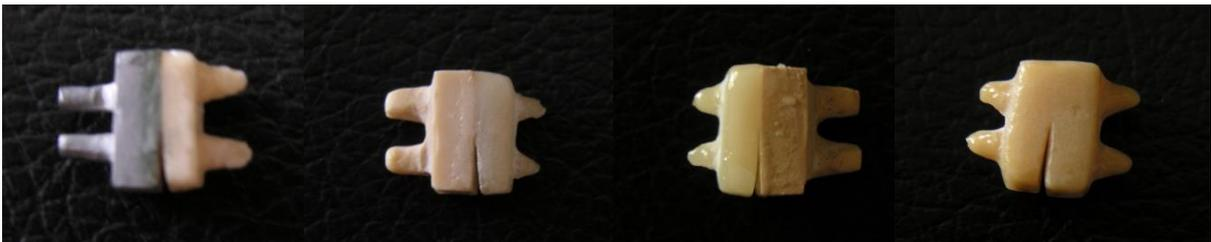
*Figura 32 - Sanduíches metal/cerâmica, alumina/cerâmica, zircônia/cerâmica e cerâmica feldspática pura.*
