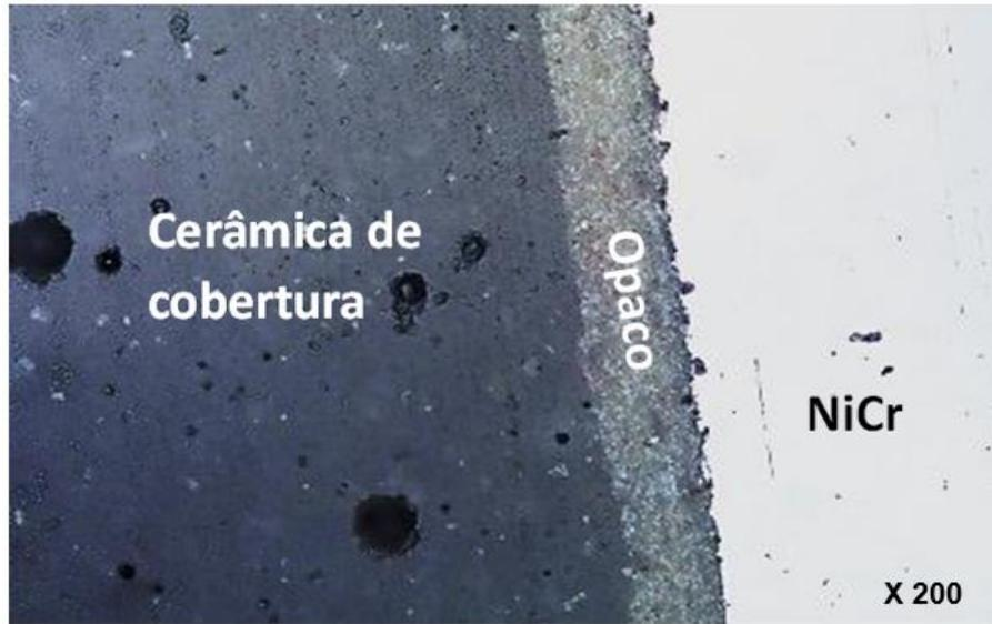
*Figura 33 - Interfaces metal/cerâmica.*
