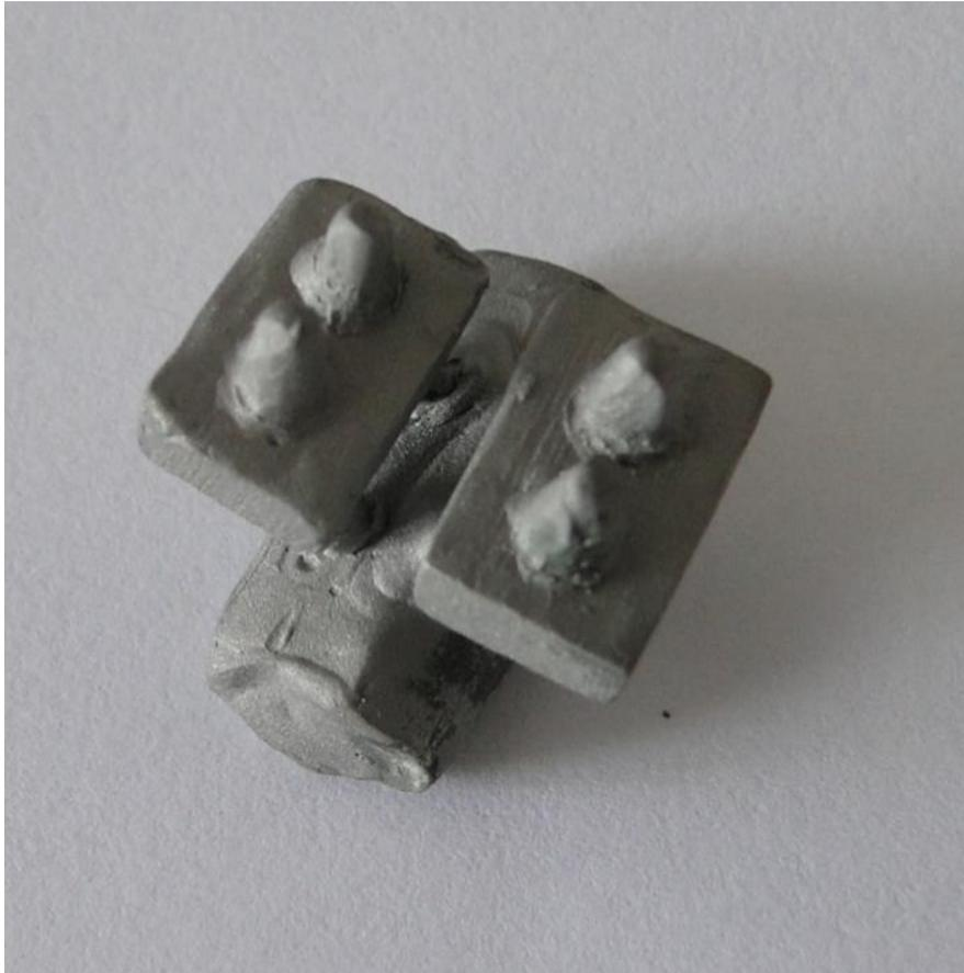
*Figura 23 - Corpo de prova de NiCr. Aqui tem-se dois corpos de prova com projeções laterais as quais servirão para melhorar a fixação da resina epóxi.*
