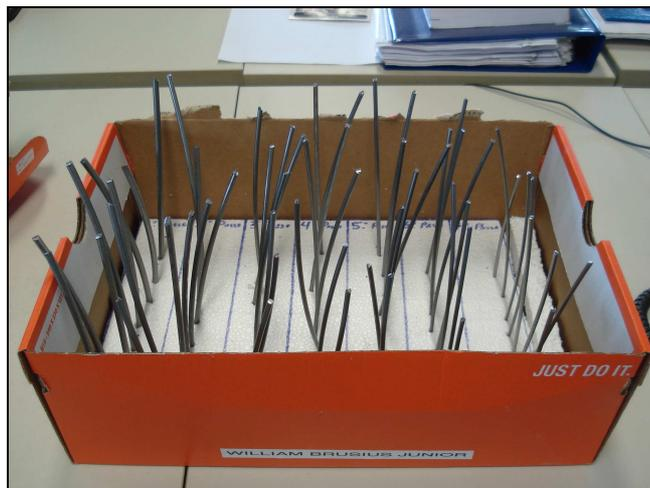
Figura 9 – Caixa de coleta de amostra para Análise de Residual de Sabão;
