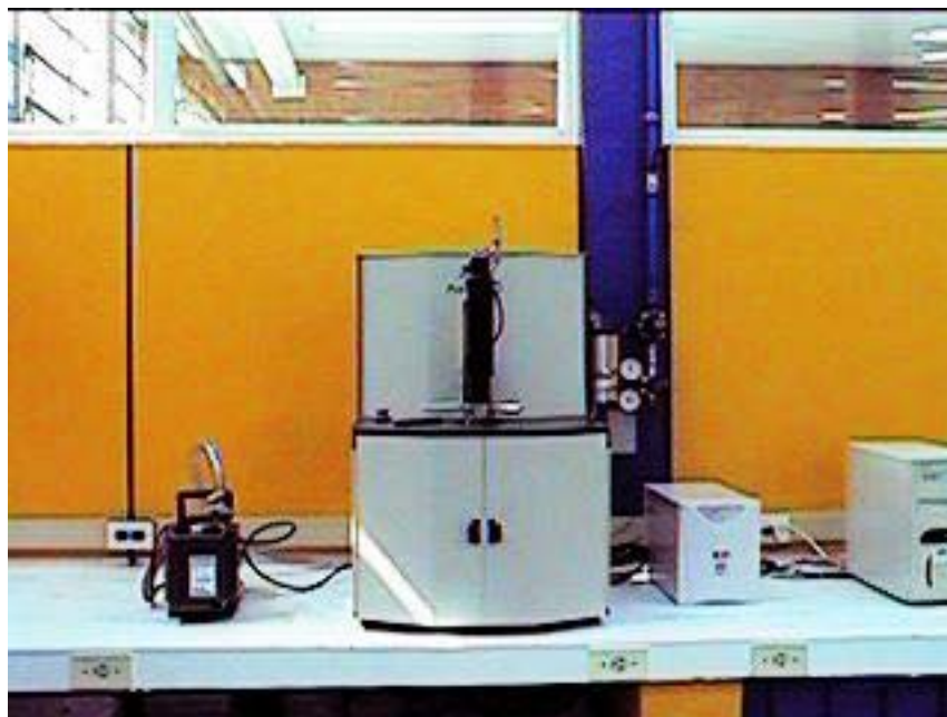
Figura 3.1. Porosímetro de mercúrio Quantachrome , modelo Poremaster .
