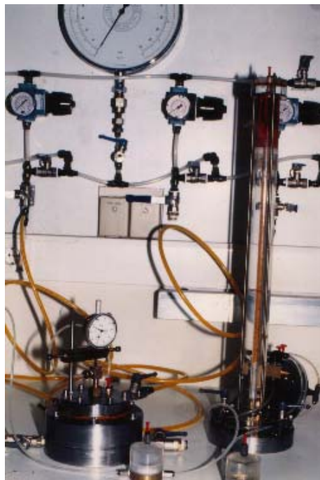
Figura 3.4. Vista geral do edômetro com controle de sucção do LMS/UFRGS.
