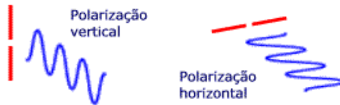
Figura 7 – Tipos de polarização utilizados em radioenlaces
