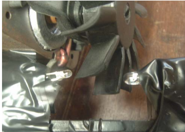
Figura 4.6: Montagem utilizada para medida da velocidade angular do motor
