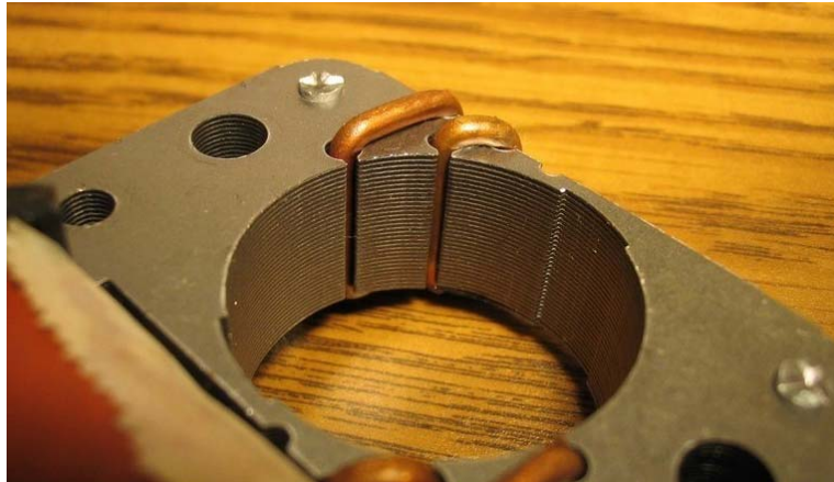
Figura 4.3: Estator detalhando os anéis de cobre em curto formando os pólos fendidos ou sombreados
