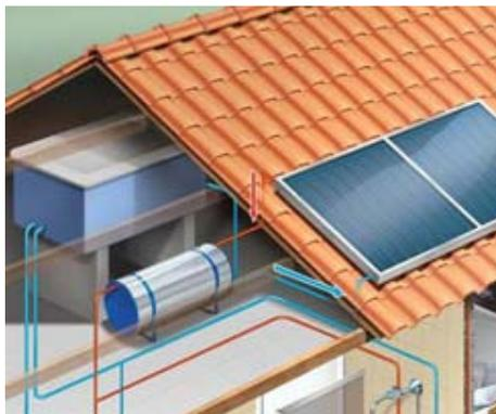
Figura 9 - Aquecimento por Placas Solares
