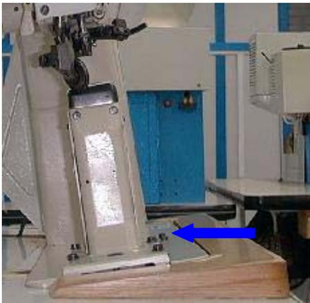
**Figura 39 - Apoio c/ inclinação posterior da máquina**
