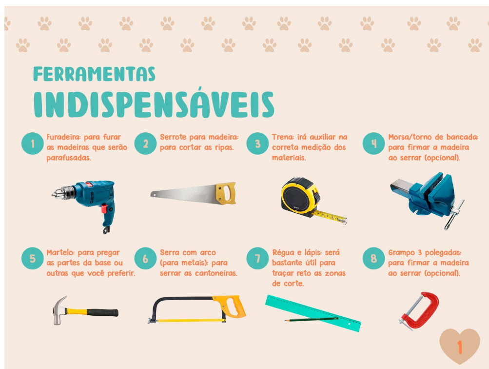
Figura 70: Ferramentas necessárias para a construção da casinha
