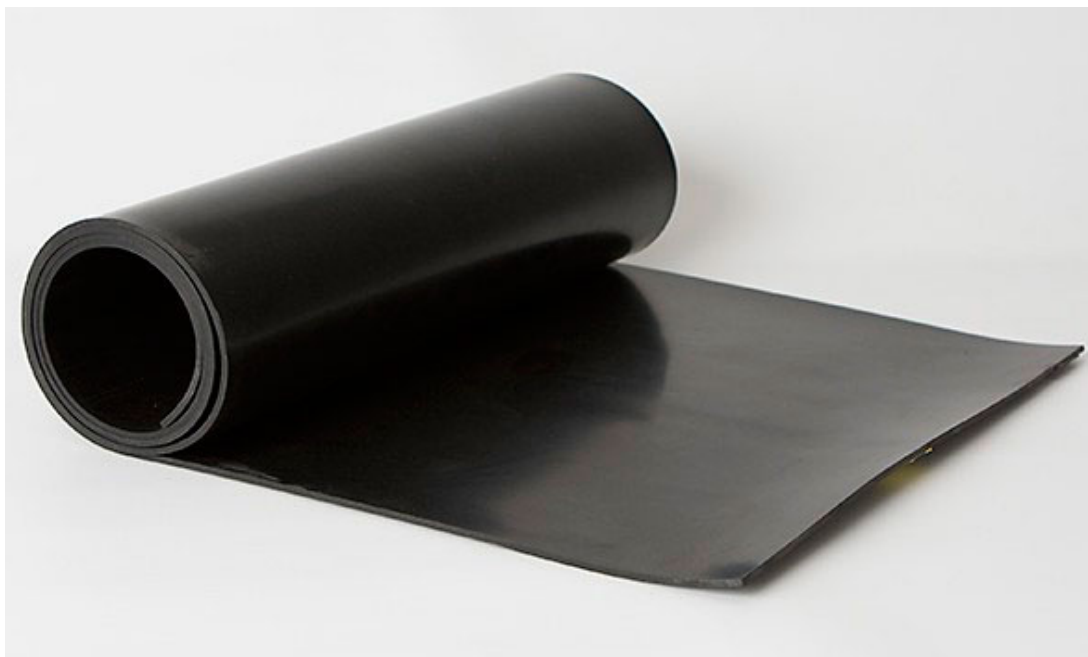
Figura 23: Borracha sob a forma de manta
