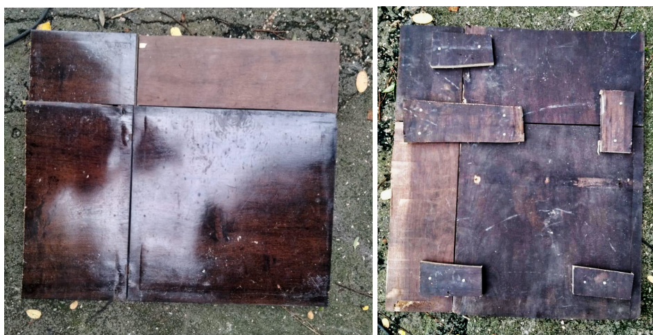
Figuras 56 e 57: Cortes feitos com ferramentas domésticas e com materiais diversos sempre apresentarão rebarbas e imprecisões
