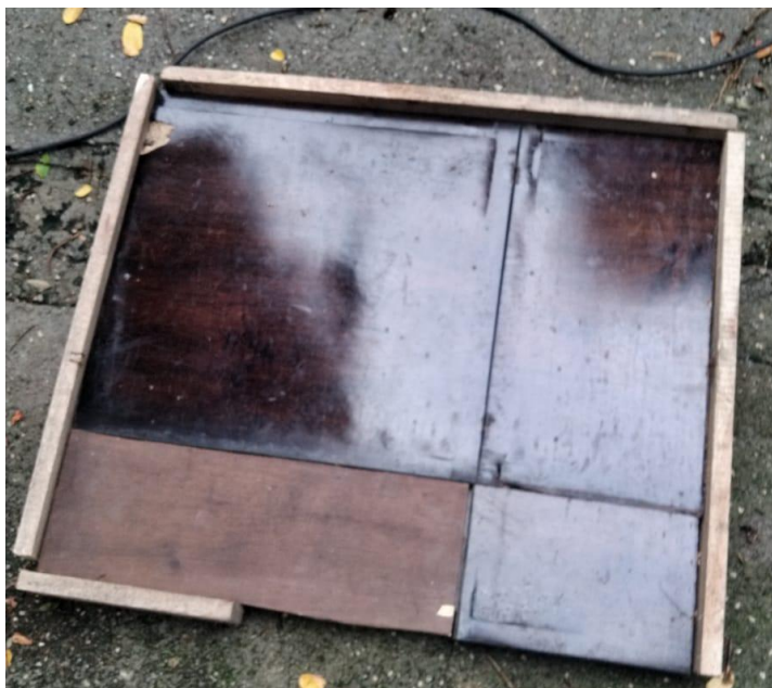
Figura 58: Base feita com sobras de madeiras mais fortes do que ripas para forro
