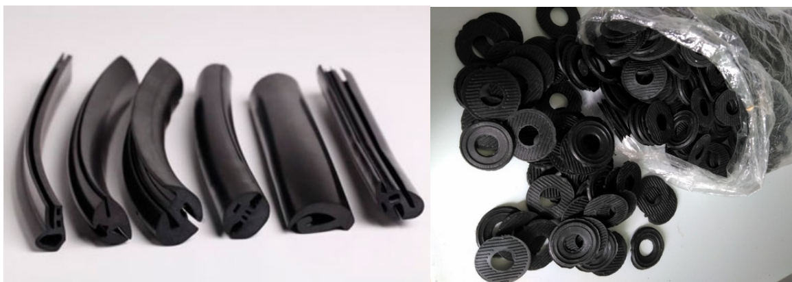
Figura 24: Borracha sob a forma de perfis e arruelas
