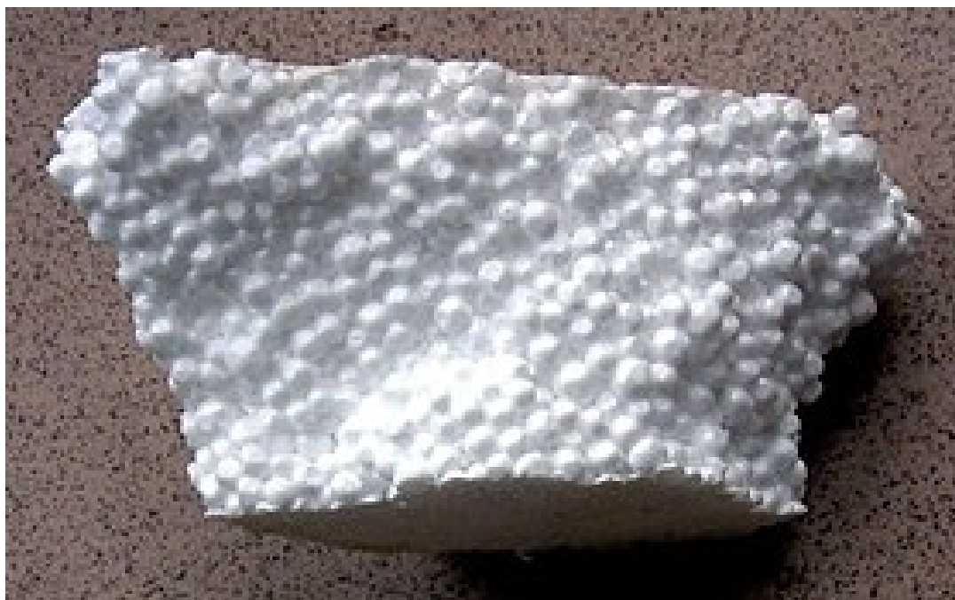
Figura 25: Poliestireno Expandido ou Expanded Polystyrene (EPS). No Brasil, é tradicionalmente conhecido como Isopor ®
