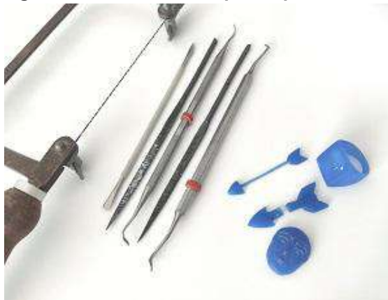
Figura 9 - Ferramentas e protótipos em cera.
