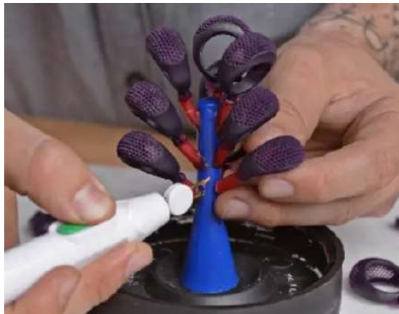
Figura 7 - Montagem da árvore de fundição.
