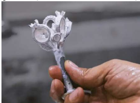
Figura 8 - Peças fundidas da árvore de fundição.
