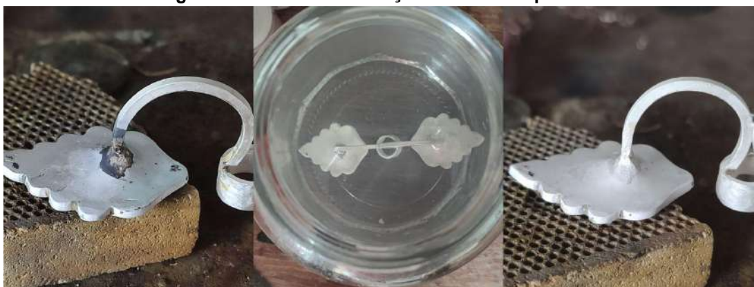
Figura 74 - Efeito da utilização do sal branqueador.
