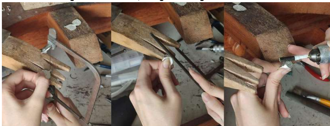
Figura 72 - Recorte, limagem e lixagem dos modelos.
