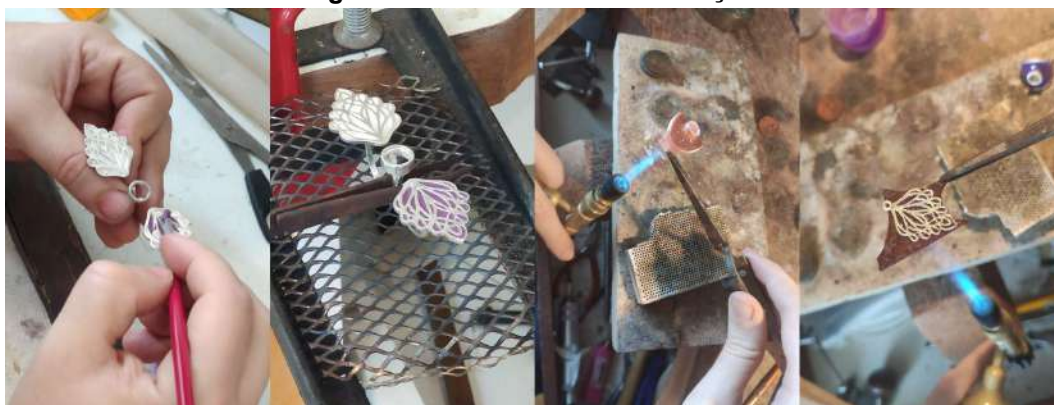
Figura 76 - Processo de esmaltação.
