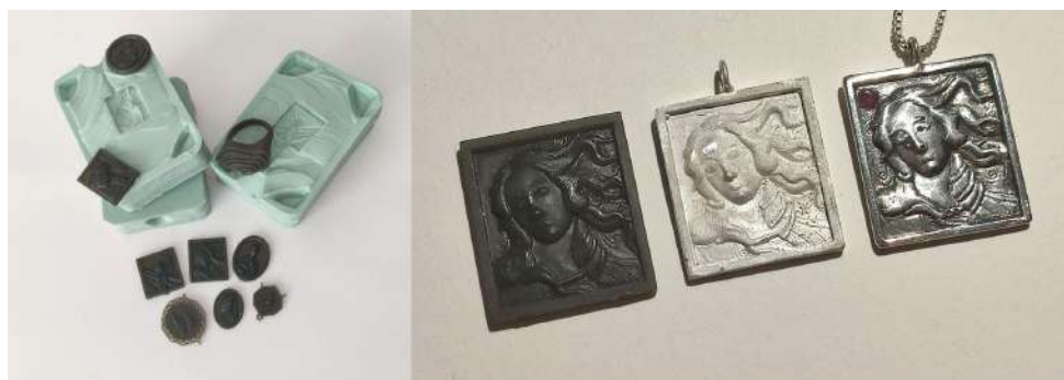
Figura 6 - Protótipos em resina, moldes de silicone e peças fundidas.
