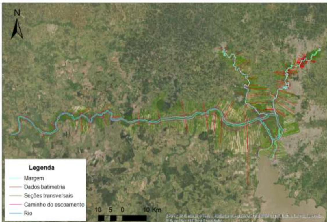
Figura 20 – Representação do modelo hidrodinâmico com as feições geométricas digitalizadas (seções transversais, rios, margens e caminho do escoamento), e identificação das seções transversais com dados de batimetria.
