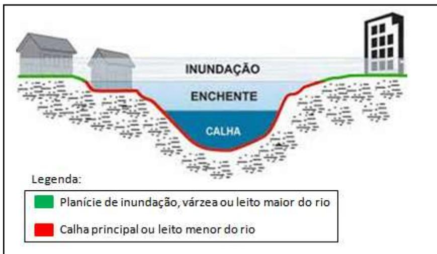
Figura 1 – Perfil esquemático do processo de cheia e inundação. (Fonte: Adaptado de IPT, 2007)
