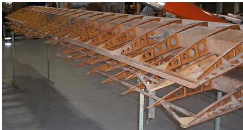
Figura 19 - Longarina composta por bastantes nervuras em uma asa (69).
