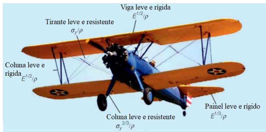
Figura 29- Componentes de um avião biplano com seus respectivos índices (93).
