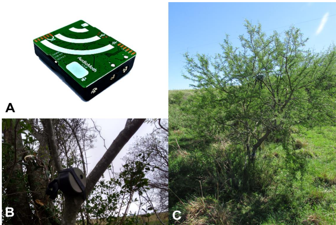
Figura 2. Exemplo de equipamento e disposição em campo utilizados para monitoramento acústico passivo. A) Gravador do tipo Audiomoth; B) Caixas de proteção contra intempéries para os gravadores; C) Gravador disposto em estruturas arbóreas em ambiente campestre.
