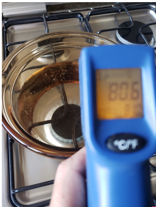
Figura 12 – As bolhas de vapor colapsam ou implodem gerando um chiado à uma temperatura ~80°C
