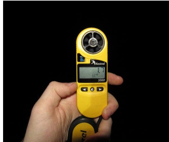
Figura 5. Condições climáticas sendo verificadas com a estação meteorológica portátil.(Foto: Dener Heiermann).
