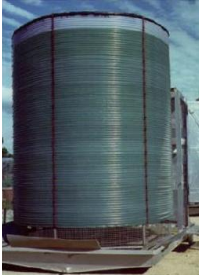
Figura 30: Esquema fotobiorreator com arranjo helicoidal dos tubos.
