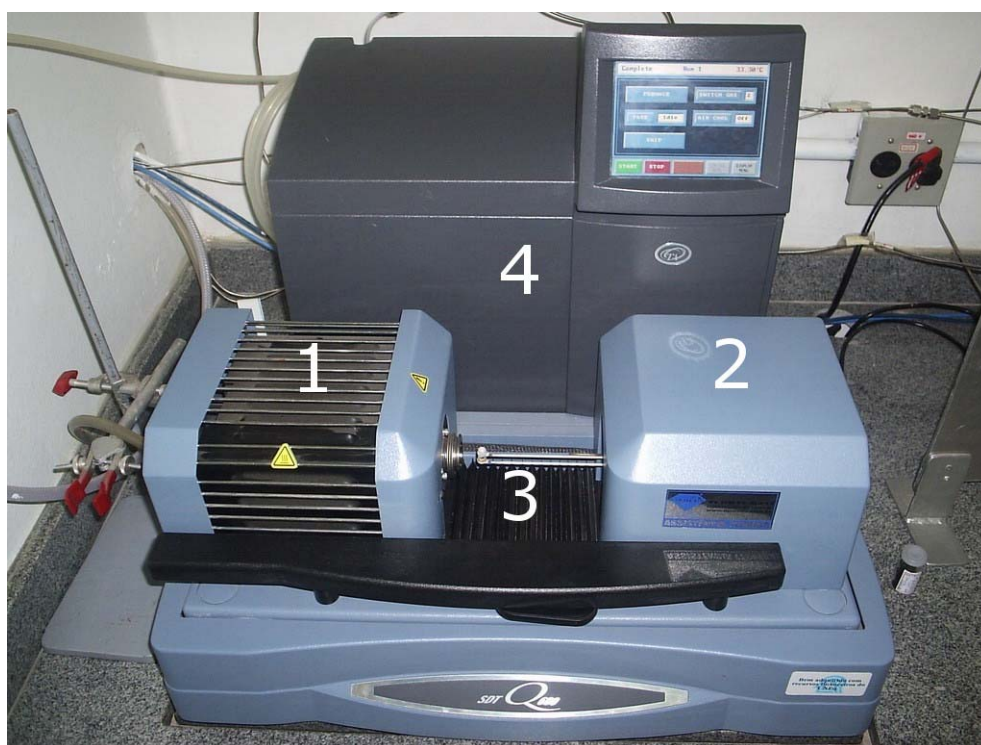
Figura 2.4: Detalhes da termobalança aberta: 1) Forno; 2) Balança; 3) Hastes da balança contendo os cadinhos; 4) Gabinete (CPU)
