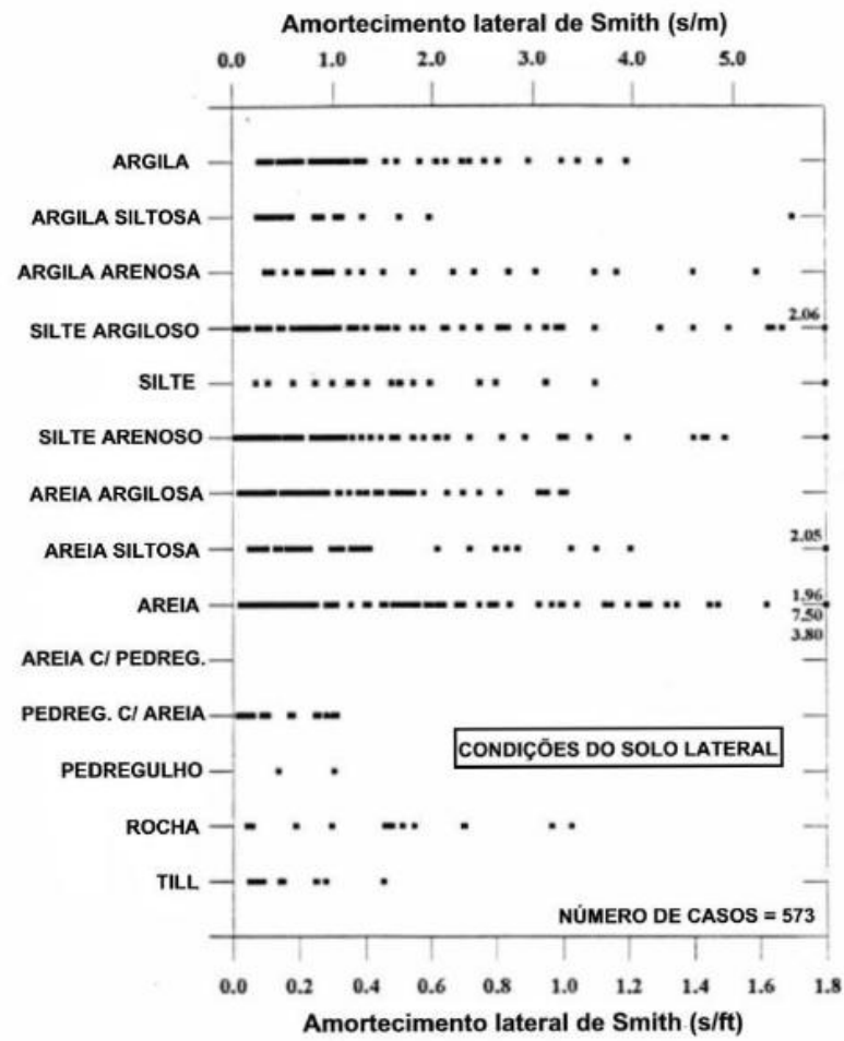
Figura 2.17: Correlação entre o coeficiente de amortecimento lateral de Smith e o tipo de solo (Paikowski & Chernauskas, 1996).
