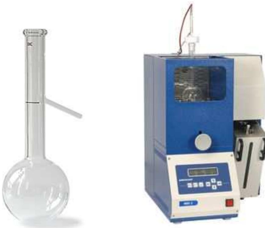
**Figura 2.2:** Balão específico para a destilação ASTM D-86 e um equipamento para a execução automática do ensaio (Petrotest ADU 4) (PETROTEST, 2010).
