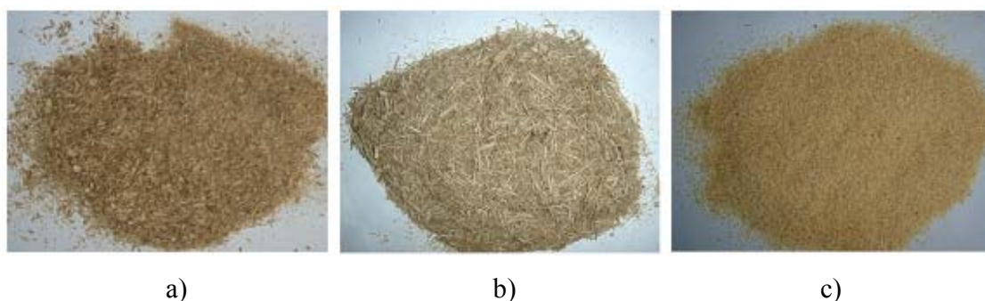
Figura 9. Imagem das cargas utilizadas: a) bambu; b) bagaço de cana; c) farinha de madeira.
