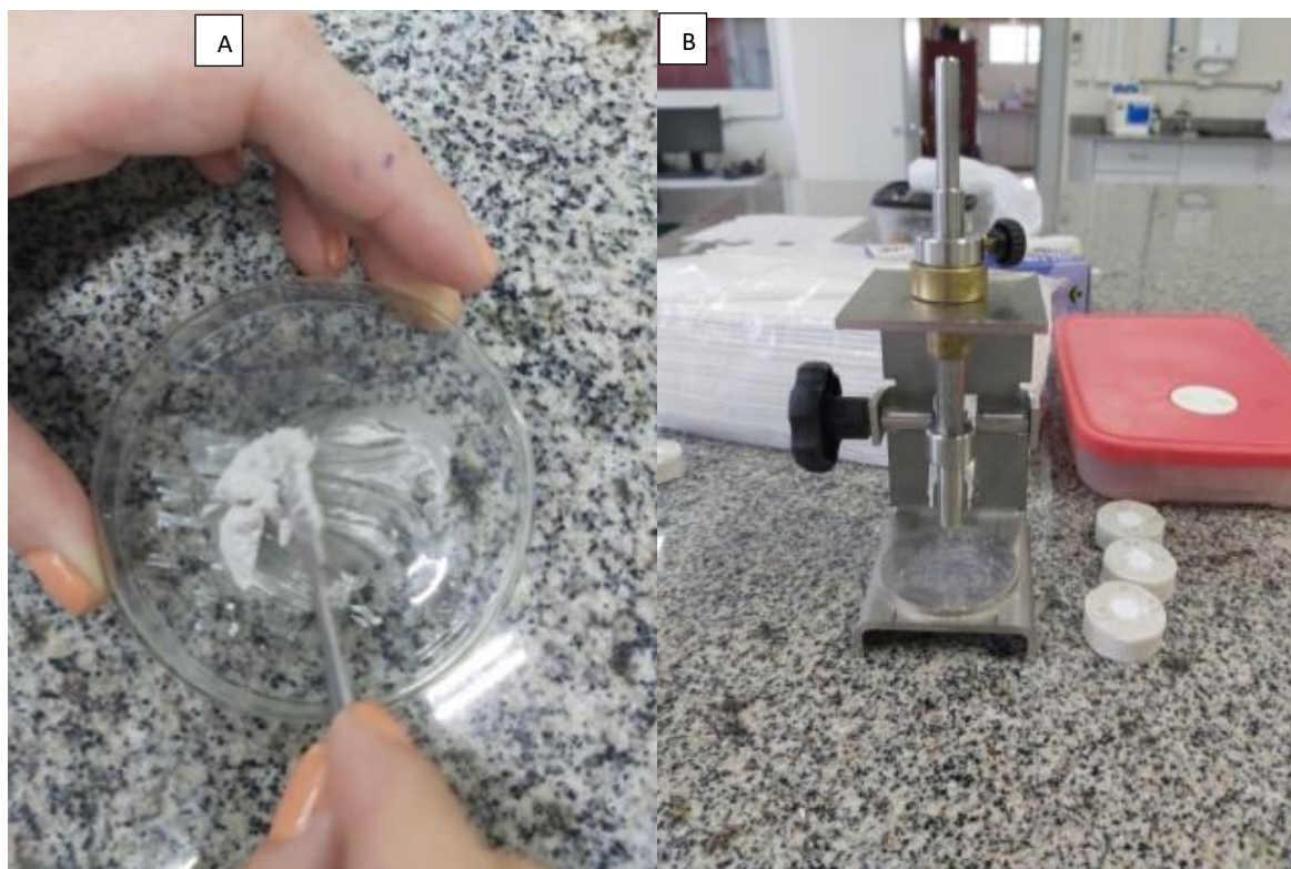
Figura 7 – (A) Espatulação do cimento. (B) Agulha tipo Gillmore e matrizes de gesso preenchidas com o cimento manipulado.
