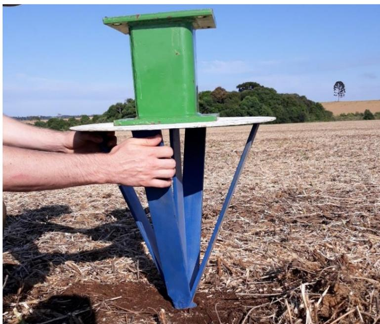
**Figura 2:** Compactômetro usado na medida de resistência do solo à deformação.
