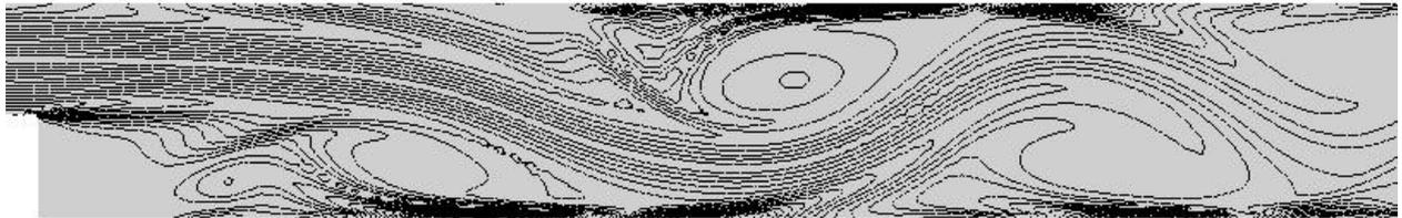
**Figura 4.74** – Detalhe da distribuição da vorticidade,  $Re=1000$ , degrau 3D, empregando 3ddin.
