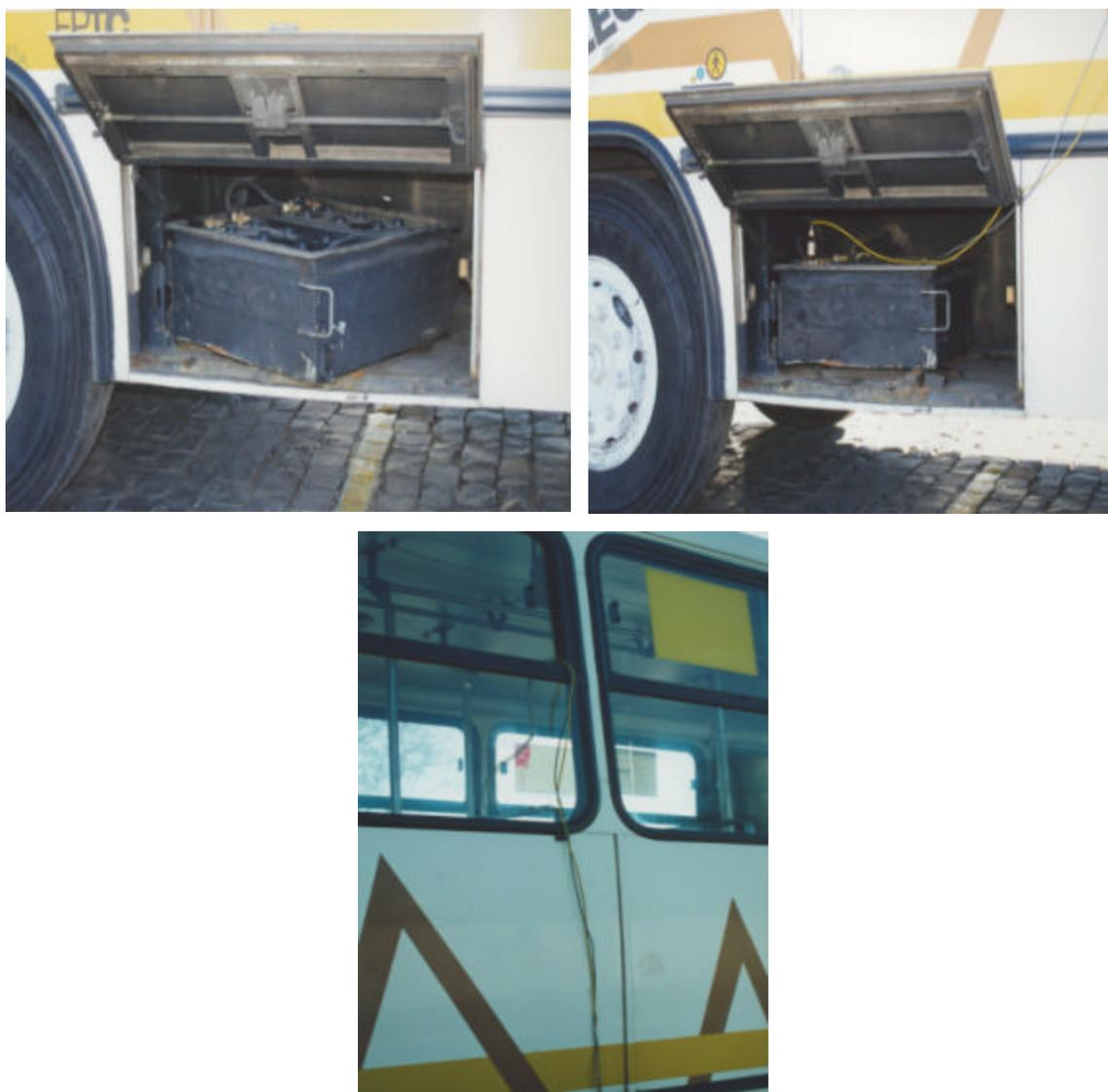
FIGURA 4.13 – Detalhe das baterias e cabos utilizados para alimentação dos equipamentos.
