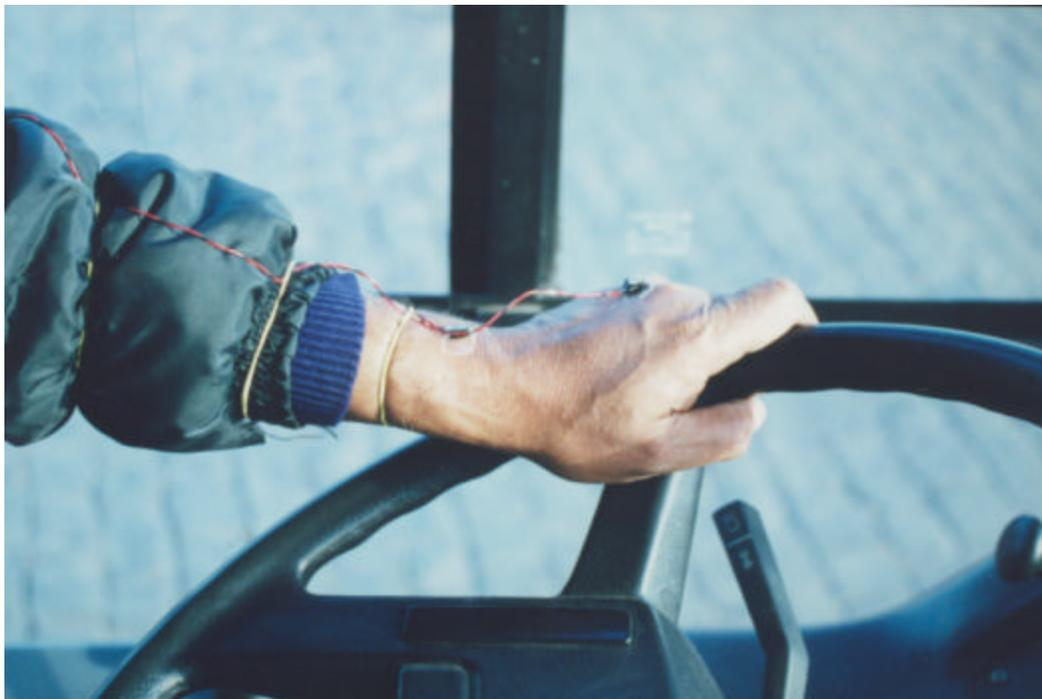
FIGURA 4.10 – Detalhe da localização dos micro-acelerômetros fixados no pulso e na mão do motorista.
