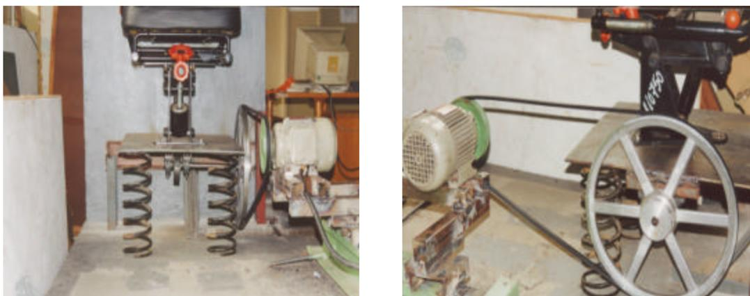
FIGURA 4.15 – Mesa vibratória com detalhe para o sistema polia-motor.
