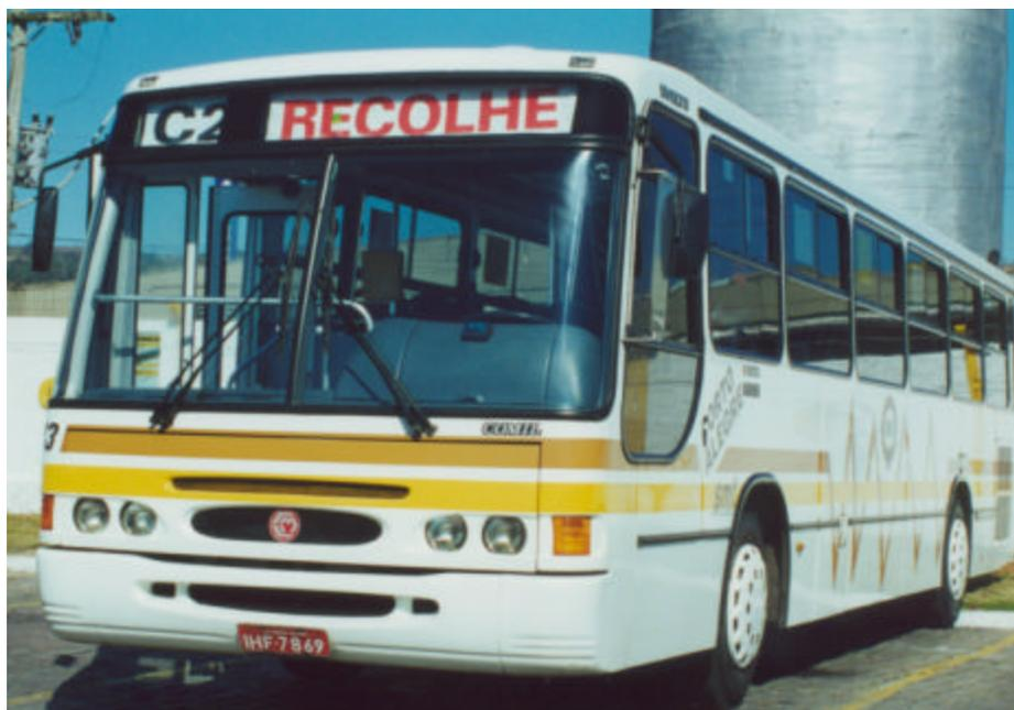
FIGURA 4.3 – Ônibus Mercedes – chassi estendido.
