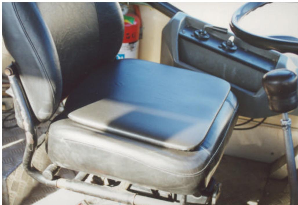
FIGURA 4.8 – Interface utilizada para permitir a colocação do acelerômetro entre o assento e o motorista.
