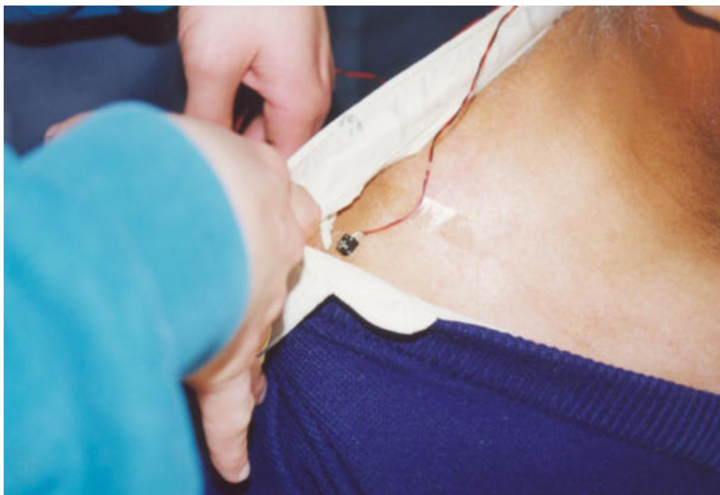
FIGURA 4.11 – Detalhe da localização do micro-acelerômetro fixado no ombro do motorista.
