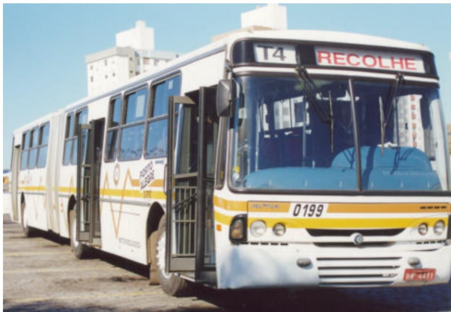
FIGURA 4.4 – Ônibus Volvo – chassi articulado.
