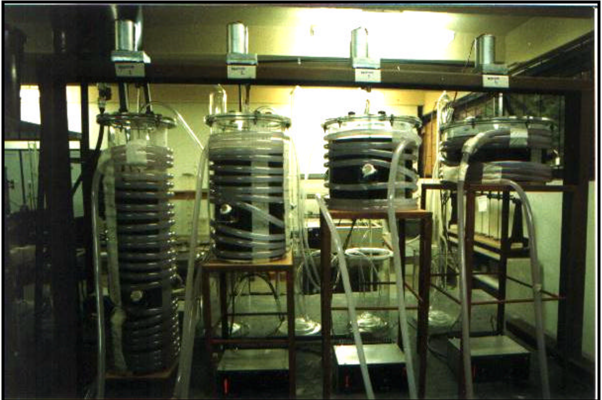
Figura 5.2 – Reatores R1.1, R2.1, R3.1 e R4.1 (posicionados da esquerda para a direita, respectivamente) em pleno estado de reação, com sistema de aquecimento externo aos mesmos, com alimentação por gravidade e descarte manual.
