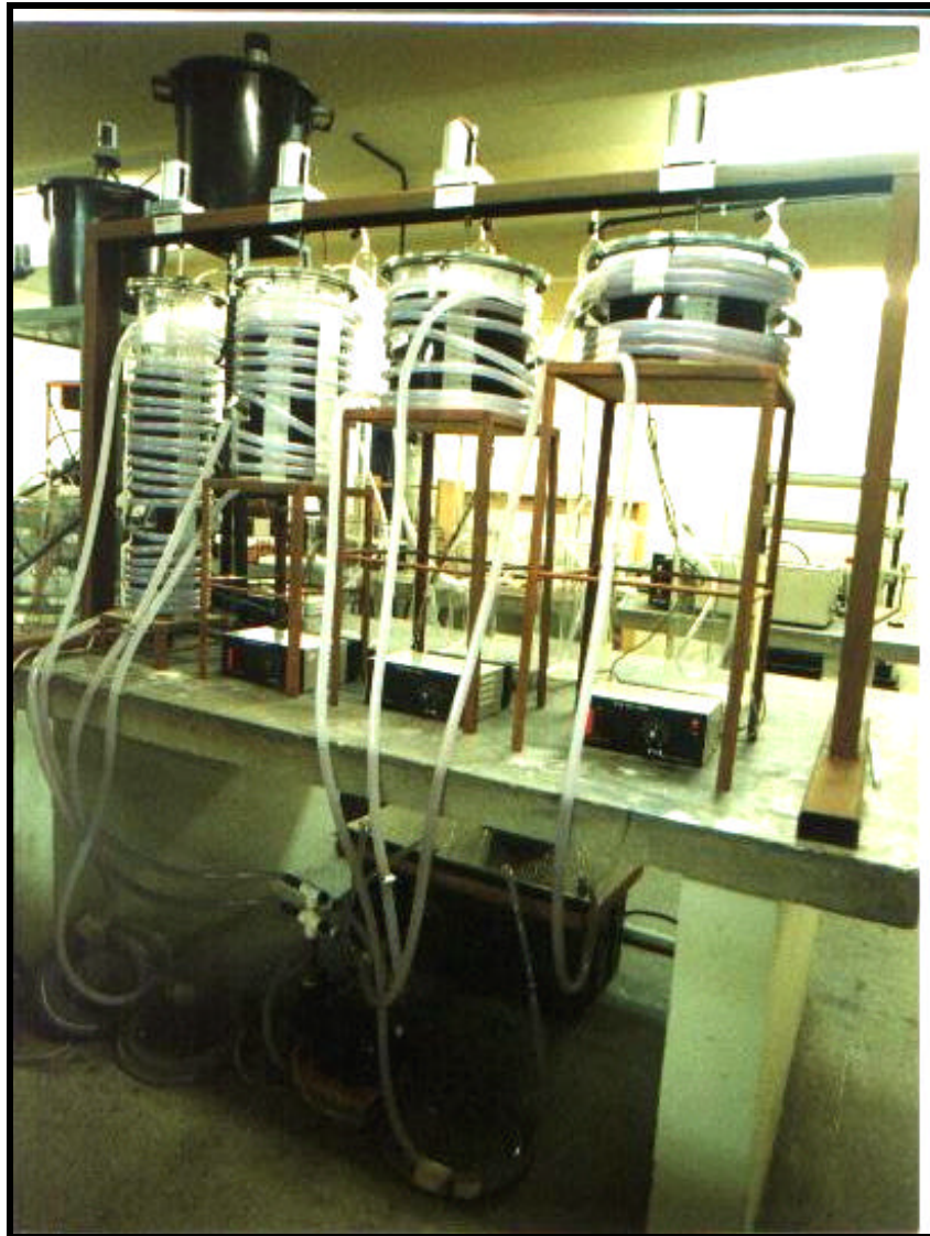
Figura 5.3: Complexo da 1ª etapa do experimento composto por: tanque de aquecimento (abaixo da bancada); bomba para circulação da água quente pelas mangueiras (abaixo da bancada e ao redor dos reatores); controladores de velocidade da agitação interna dos reatores (a cima da bancada, abaixo de cada reator); reservatório de alimentação por gravidade (direita, a cima da bancada).
