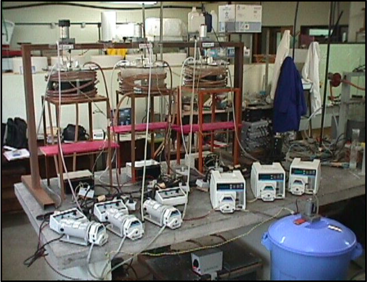
Figura 5.6 – Três bombas peristálticas para alimentação (direita) e três bombas peristálticas para descarte (esquerda); reservatório com sistema de agitação para evitar sedimentação de macro e micro nutrientes; termostato para controle da temperatura da água de circulação para o aquecimento dos reatores (abaixo da bancada).
