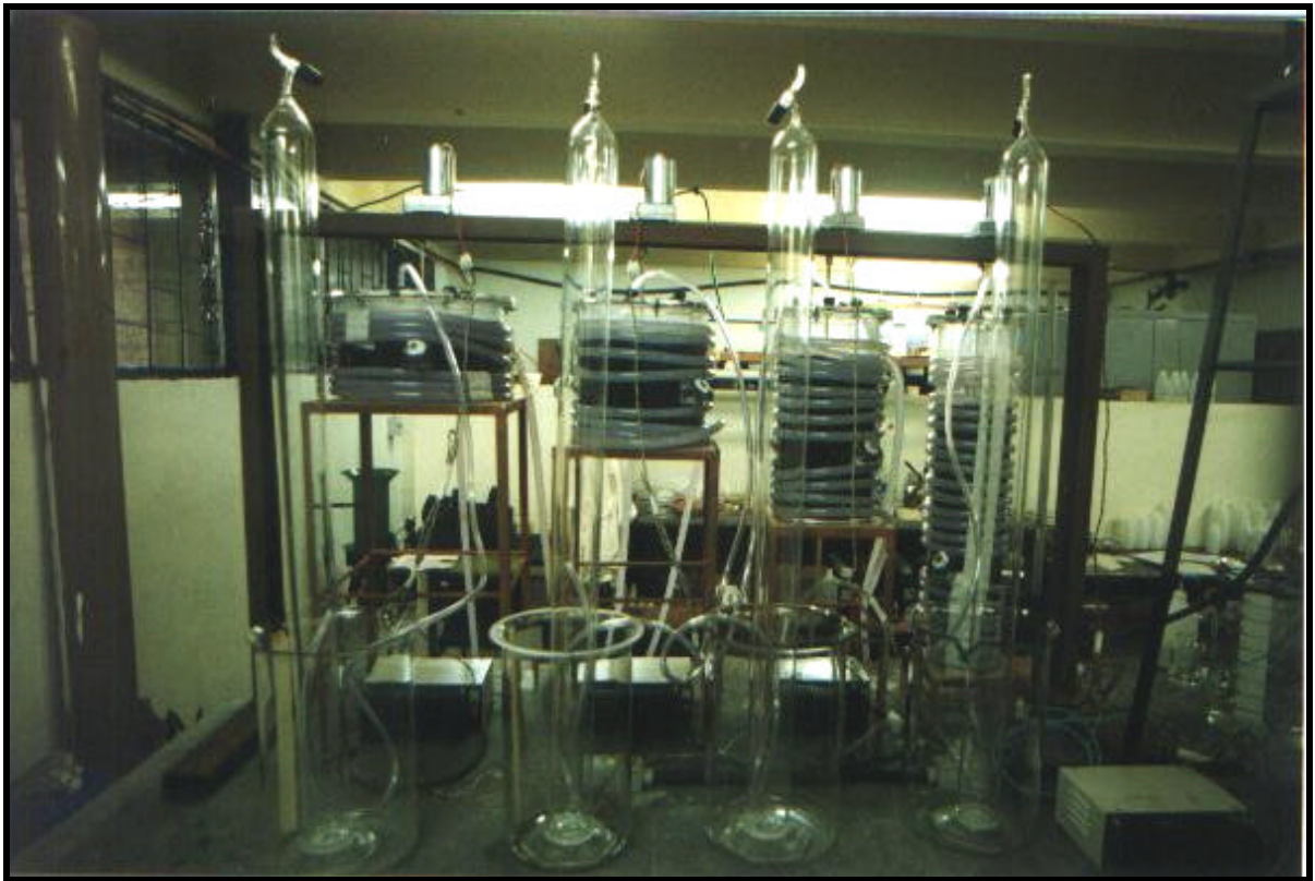
Figura 5.4: Sistema de medição de gás por deslocamento de coluna d'água.
