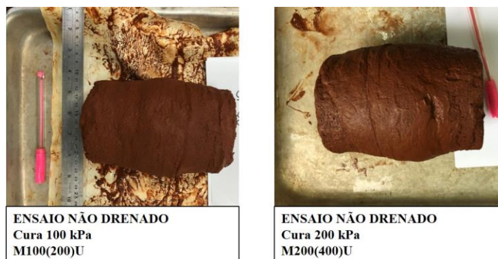
Figura 4.18: Corpos de prova após o cisalhamento para ensaios com tensão efetiva maior que a tensão de cura
