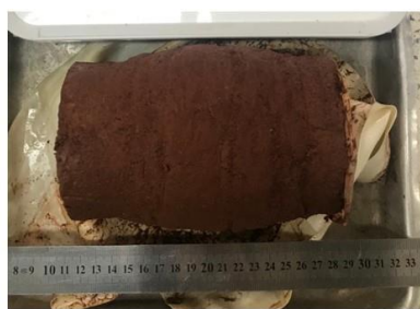
b) ENSAIO NÃO DRENADO Cura atmosférica M000(200)U
