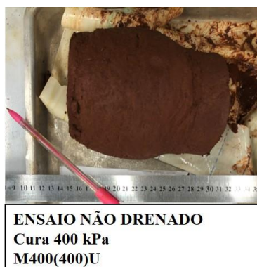
Figura 4.13: Corpo de prova M400(400)U após o cisalhamento
