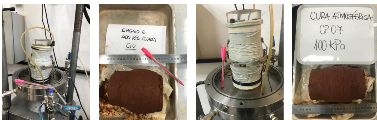
Figura 4.2: Forma típica do corpo de prova após os ensaios
