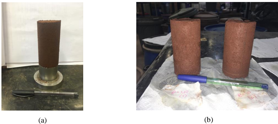
Figura 3.11: Corpo de prova após moldagem (a). Corpos de prova após sujeitos à imersão (b)
