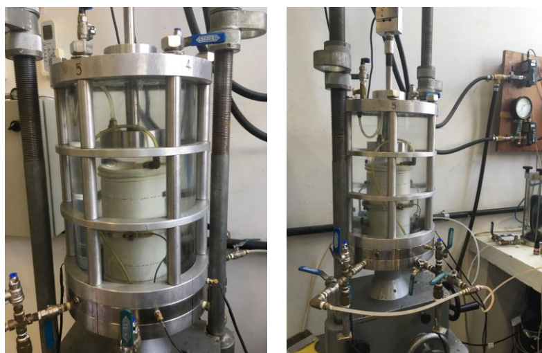
Figura 3.22. Câmara triaxial fechada e preenchida por água
