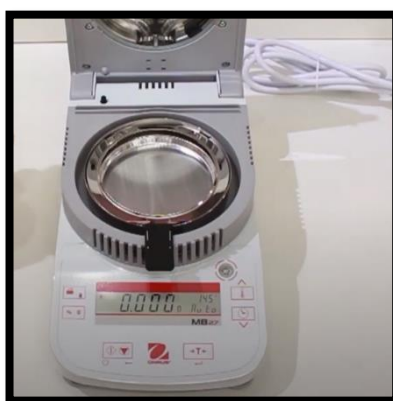
Figura 17: aparelho medidor de umidade usado para amostras de farinhas.
