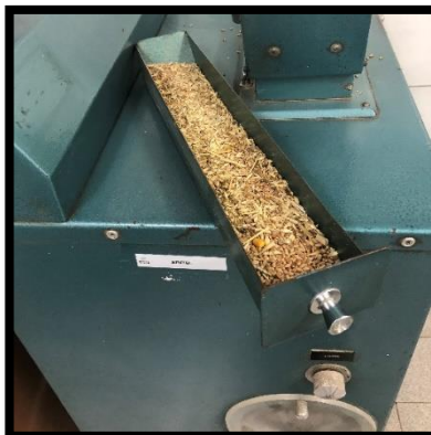
Figura 18: aparelho separador de impurezas das amostras de grão do trigo.
