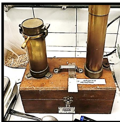
Figura 19: aparelho medidor de Peso Hectolitro das amostras de grão do trigo.
