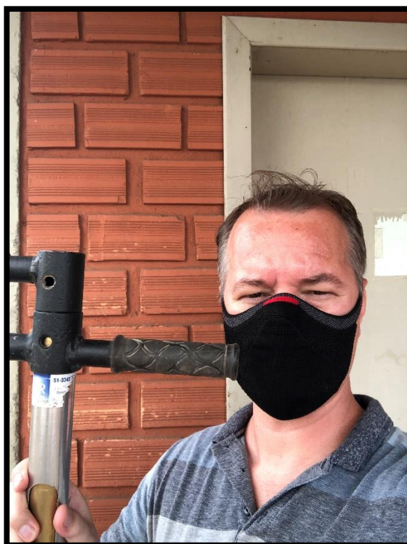
Apêndice A: Fotografia do autor segurando uma sonda manual de coleta de amostras – usada na carga dos caminhões carregados de grãos de trigo que chegam na empresa.
