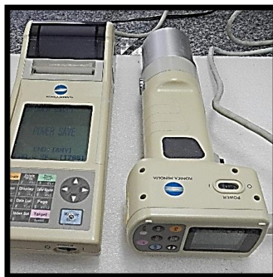
Figura 20: aparelho Minolta usado para aferir a cor das amostras de farinha.
