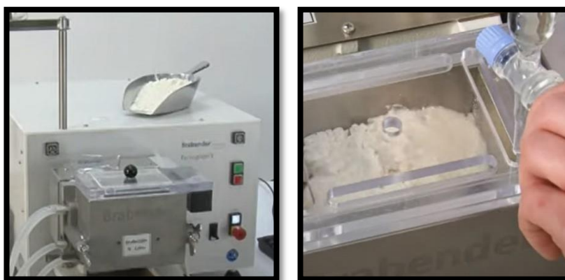
Figura 23: aparelho Farinógrafo de Brabender; Figura 24: detalhe do local de adição de amostra de farinha e água a ser analisada pelo Farinógrafo.
