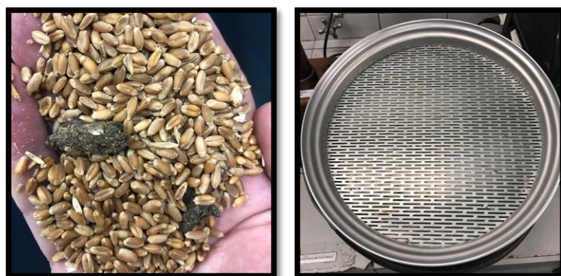
Figura 11: trigo de amostra com presença de impurezas; Figura 12: malha de aço para retenção e avaliação de impurezas de amostra de grão de trigo.
