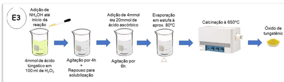
Figura 5. Rota sintética para obtenção de óxido de tungstênio adicionando o agente estruturante ao final da reação e sem etapa de refluxo.
