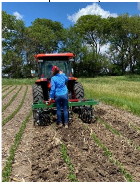
Figura 11: Equipamento utilizado para construção de camalhões em soja.
