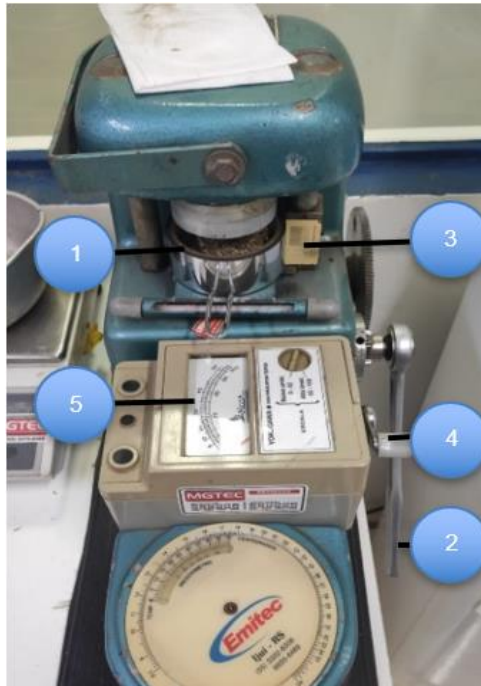
Figura 6: Medidor de umidade de grãos. Fonte: Autor.
