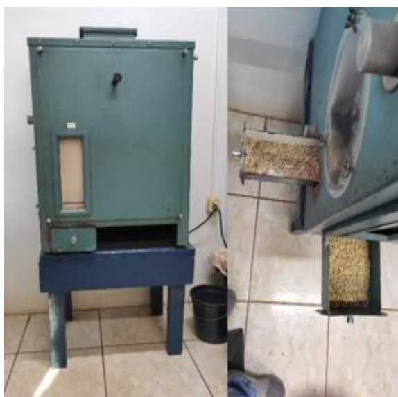
Figura 4: Separador de impurezas. Fonte: Autor.
