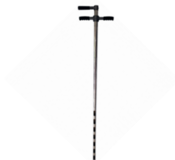
Figura 2: Calador manual (2,10 metros). Fonte: Autor
