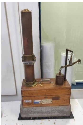
Figura 8: Balança de peso hectolitro. Fonte: Autor.
