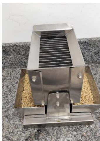
Figura 9: Quarteador de sementes. Fonte: Autor.
