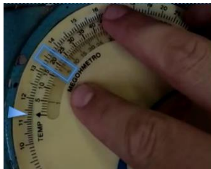
Figura 7: Indicador de umidade dos grãos. Fonte: Autor.
