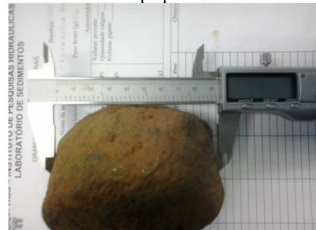
Fig. 16: Medição de partículas grandes com paquímetro
