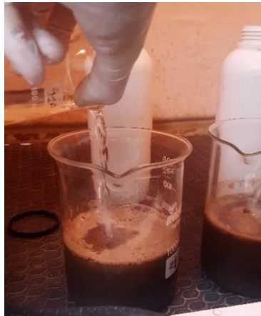
Fig. 9: Adição de Peróxido de Hidrogênio ( H_2O_2 ) para promover oxidação da matéria orgânica
