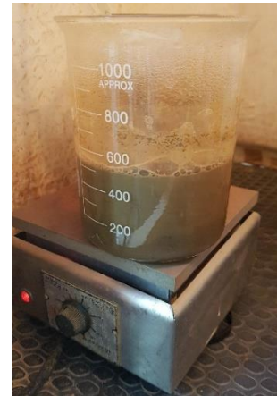
Fig. 10: Aquecimento da amostra para acelerar liberação do CO_2 .
