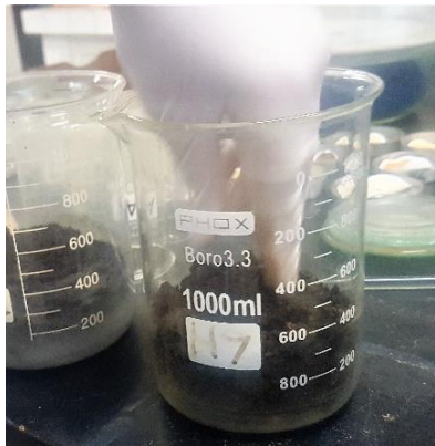
Fig. 9: Adição de Peróxido de Hidrogênio ( H_2O_2 ) para promover oxidação da matéria orgânica
