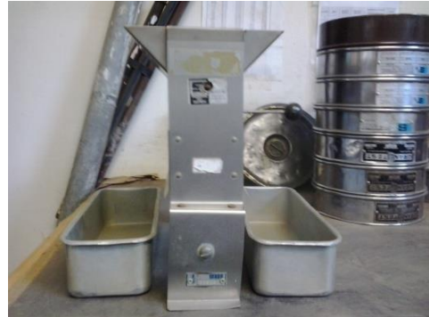
Fig. 6: Instrumento quarteador de amostras
