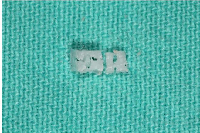
A figura 1 mostra o compósito de PABT/BAGNb com a arquitetura tridimensional e a estrutura de poros. A porosidade média foi de 72,17% ( $\pm 6,94$ ), com poros de 465,03 $\mu\text{m}$  ( $\pm 25,84$ ) (Ulbrich, 2021).
