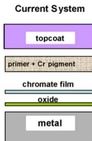
Figura 1. Esquema do atual sistema de pintura industrial contendo Cr(VI) [14].
