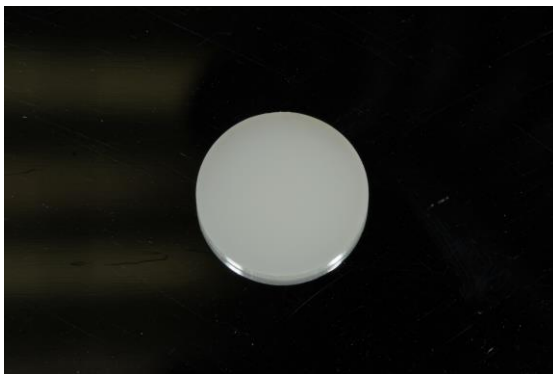
Figura 4 - Vista frontal do corpo de prova de resina composta
