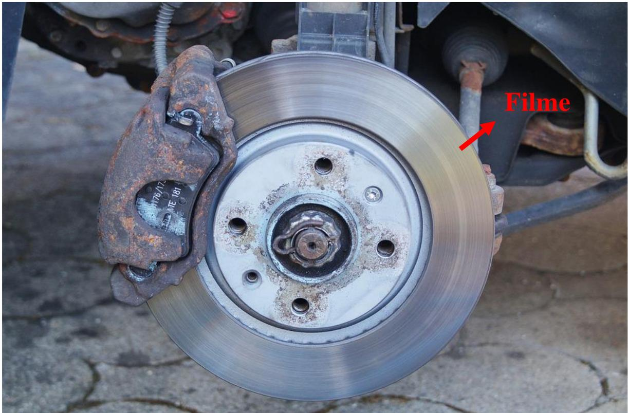
Figura 4.17 – Filme depositado sobre o disco de freio de um veículo.
