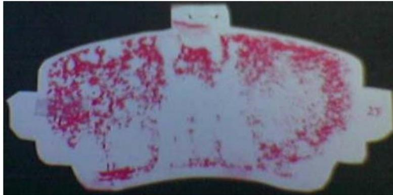
Figura 4.8 – Filme mostrando a distribuição de pressão no contato entre disco e pastilha de freio [Adaptado: Bakar et al., 2006a].
