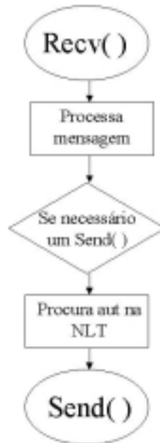
FIGURA 5.3 – Funcionamento de um autômato RS distribuído
