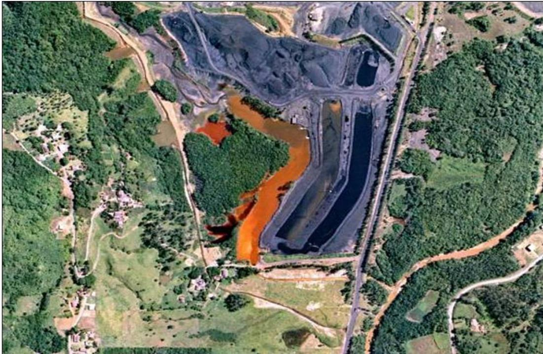
Figura 3.1 DAM na região carbonífera de SC. Mina Esperança, Criciúma (Google Earth<sup>®</sup>, 2008).
