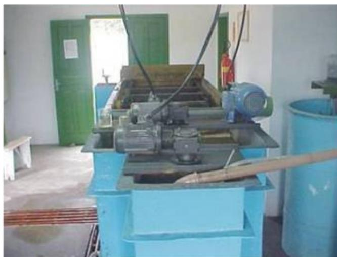
Figura 3.4 Estação de tratamento de DAM da carbonífera Metropolitana (5-10 m<sup>3</sup>h<sup>-1</sup>) - Processo NF-FAD.
