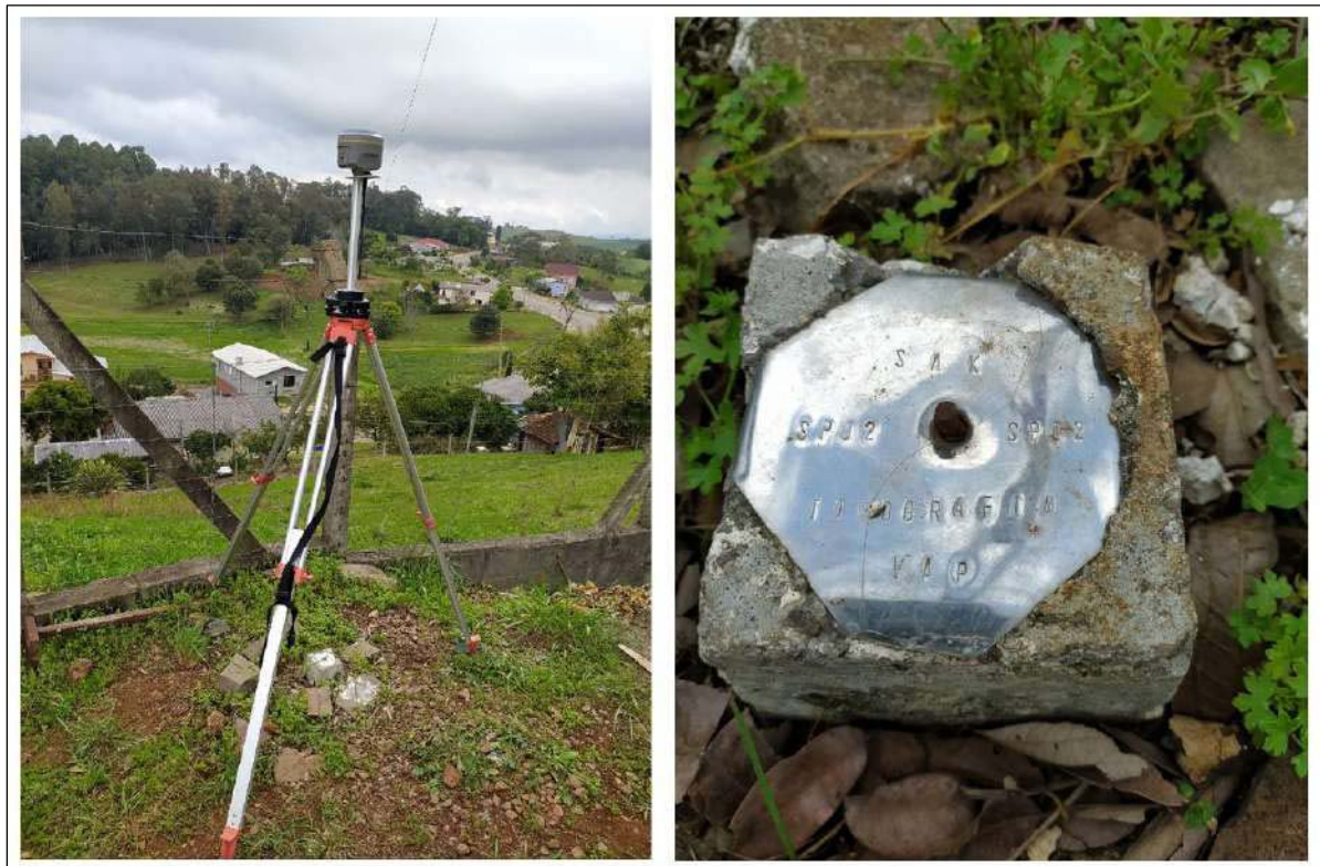
Figura 15 - Receptor base GNSS e marco utilizado para levantamento geodésico
