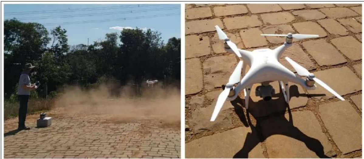
Figura 17 - Execução do levantamento aerofotográfico com utilização de drone
