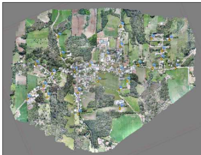
Figura 20 - Nuvem de pontos densa após a realização da fototriangulação
